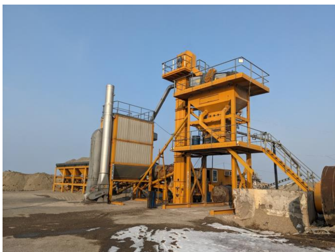
本事業で設置したアスファルト・プラント (出典：外部評価者撮影)
