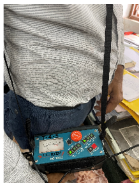
PWD Ponda (Khadpaband) の漏水探知機。機能している。
