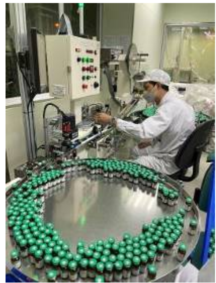
ラベリングシステム (ワクチン製造工程の一つ)
