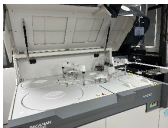
写真 3 タイビン省小児病院に設置された自動生化学検査装置
