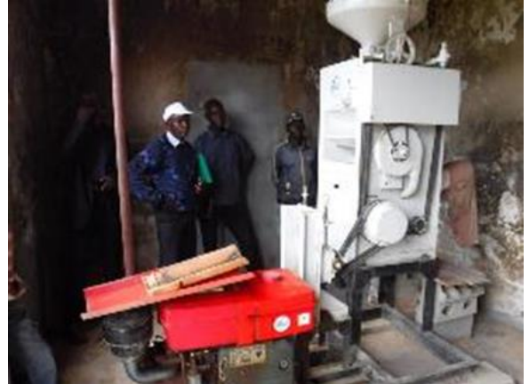
ウアンボ州の IDA が設置した精米機
