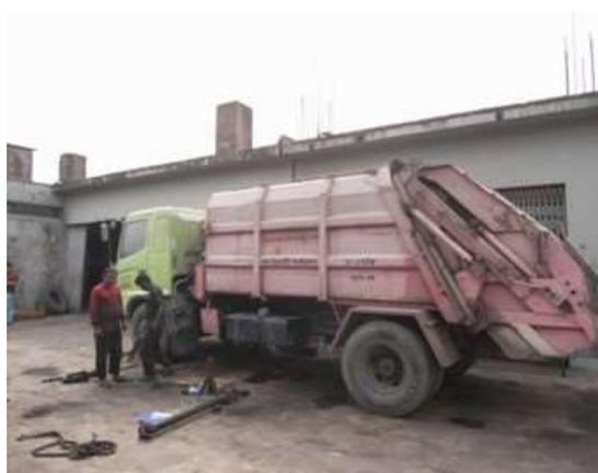
写真3. 北ダッカ市役所 Gabtoli 車両整備場でのコンパクター車のドライブシャフト修理の様子（2024年3月、評価者撮影）
