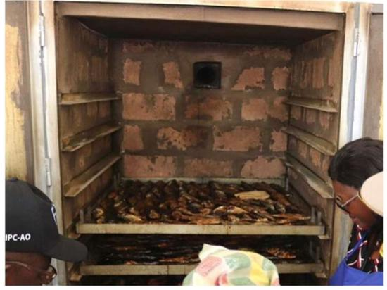
写真4：FAO 設置の燻製用オーブン
