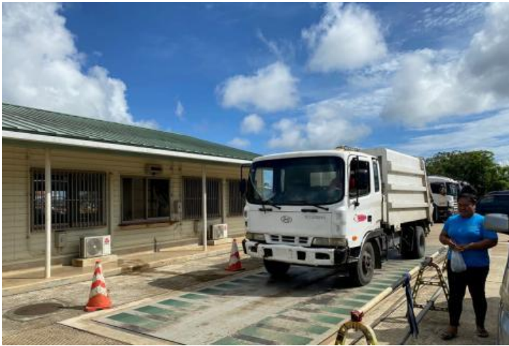
写真 1：廃棄物処分場入り口のスケール (出典：外部評価者撮影)
