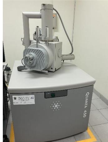
写真 8 走査型電磁顕微鏡
