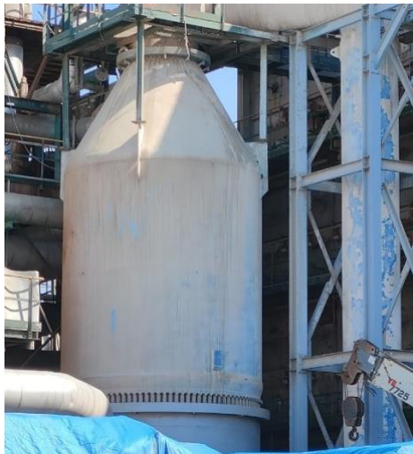
写真 2：本事業で調達された二次改質炉 (出典：評価者撮影)
