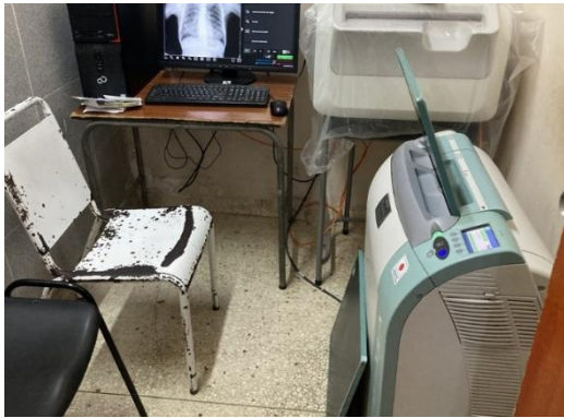
写真3 CRリーダーでカセットから画像を読み込んでいる
