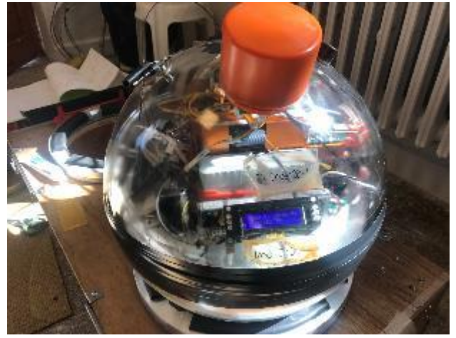
KOERI に供与された海底地震計は良好な状態が維持されている
