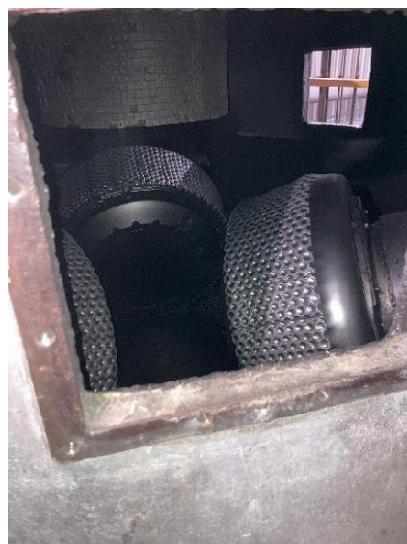
写真2: 微粉炭機ローラ（セラミック製） （出所：評価者撮影）
