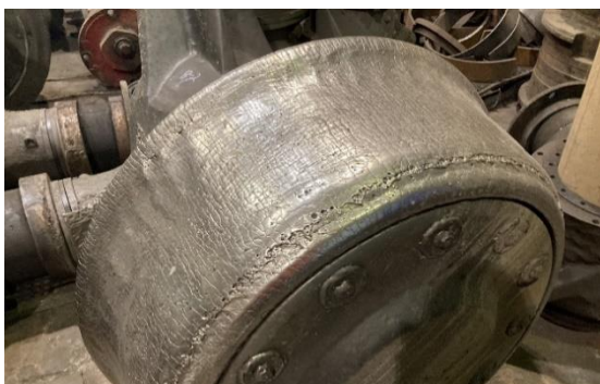
写真3: 旧型（金属製）の微粉炭機 （摩耗状態を示す。年1回、修理・再利用されている）（出所：評価者撮影）
