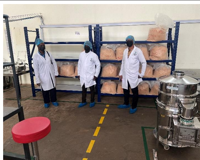
Yedent Group of Companies (ボノ州) カイゼン 5S の実践 (床のマーキングによる配置などの標準化が維持されている)
