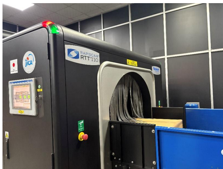
EDS を用いた貨物の爆発物検出の様子
