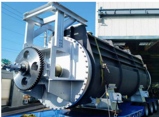
油温減圧式乾燥機本体 (容量 20 m 3 、シリーズ最大級を誇る新型クッカー)
