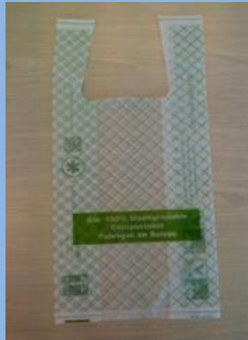
カネカ製PHBH*系コンパウンドから製造する生分解性の袋
