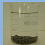
④ 凝集・沈殿
