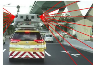
MMS車による3次元点群データ*の取得 ※x, y, z座標の位置情報を持つ点の集合
