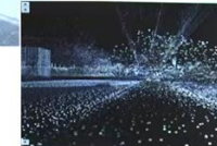
MMS車による3次元点群データ*の取得 ※x, y, z座標の位置情報を持つ点の集合
