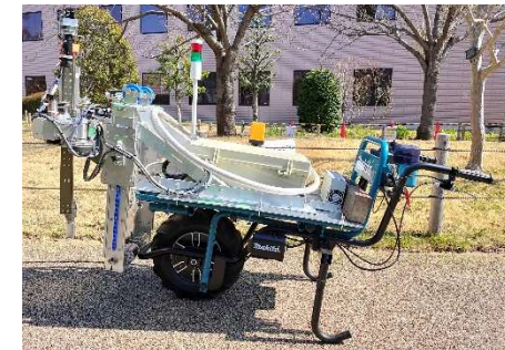
プロトタイプDMR-4 圧縮空気型地雷原掘削装置
