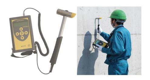
本事業では、ナイジェリアの道路維持管理のうち、特に橋梁のメンテナンス改善のため、 日東建設株式会社のコンクリートテスター(以下、CTS)を導入し、首都アブジャにおいて 橋梁の点検技術の実証を行います。同社の CTS は、ナイジェリアから引き合いがあり、既 に納品経験もあります。CTS は非破壊によるコンクリートの圧縮強度推定装置で、ハンマに 内蔵したセンサーで打撃力を測定・解析することにより対象物の強度を簡便かつ高精度に 測定します。また、コンクリートの圧縮強度のみではなく、付加情報としてコンクリート の表面劣化度合いや表面近傍の浮き・剥離の検出も可能です。本装置は、本体とハンマユニットから構成された小型・軽量の測定装置で機動性に優れており、機械的な作動要素がないため、頻繁な校正試験や部品交換の必要がないのも特徴です。点検要員の技術不足をカバーした均一な計測データの記録・蓄積が可能であり、測定結果は装置本体に蓄積されるため、同結果に基づき対象となる構造物の健全度を分析することができます。
