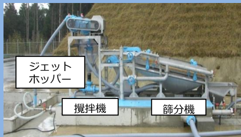
ろ過池更生システム（更生工事） 「高速度篩分け洗浄機」 —ろ過砂を洗浄し揉み洗い、粒度を調整し、再びろ過に適した状態に再生（再利用） —浄水場（ろ過池）の処理能力を回復
