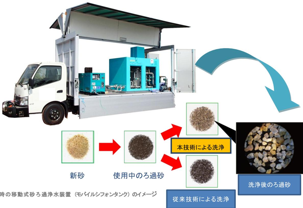
今回の実証事業では、「ろ過池更生システム」と「移動式砂ろ過浄水装置（モバイルシフォンタンク）」の2つの現地適用性の調査を予定しています。1つ目の「ろ過池更生システム」では、ろ過池の中にあるフィルターの役割をするろ過砂を、高速度篩分け洗浄機によって揉み洗いして粒度を調整します。洗浄されたろ過砂は、再びろ過に適した状態でろ過池に戻され、ろ過池の処理能力を回復させます。また、洗浄の過程で薬品を一切使用しないことも特徴です。
