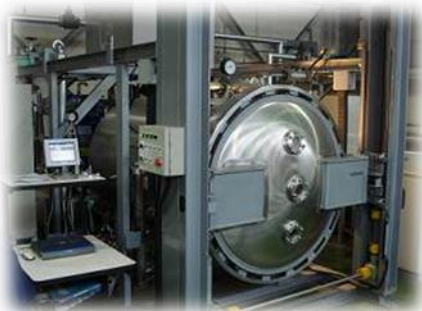
㈱サムソン製の調理殺菌装置。パックに入れたまま、食材の加熱調理と殺菌が可能。
