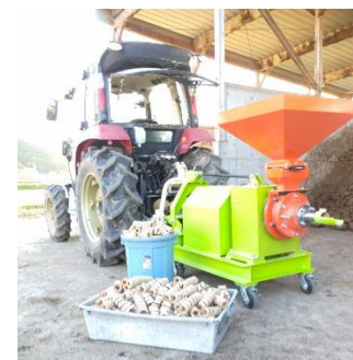
トラクターと連結したPTO仕様 もみ殻固形燃料製造装置
