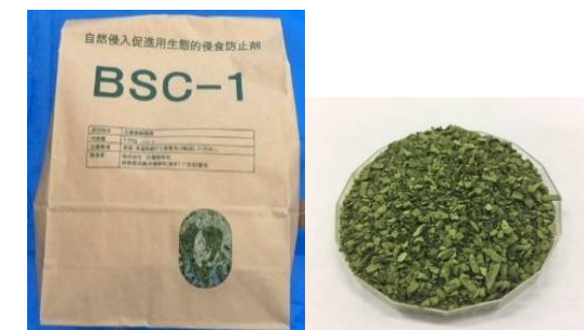
工法に使用する資材 (BSC-1)
