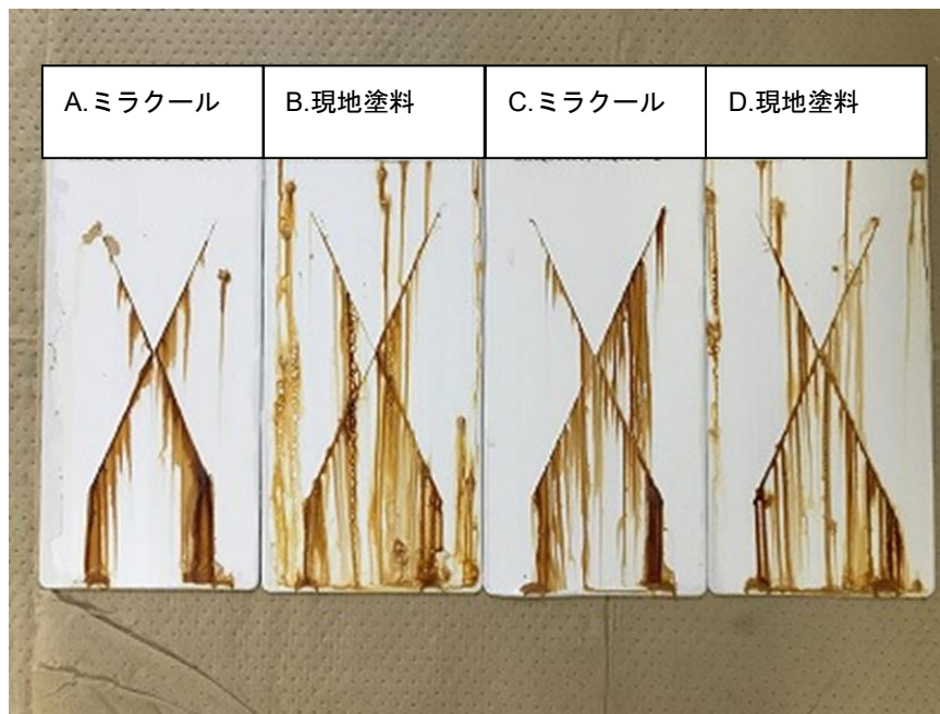
図 8 防錆性の比較結果
