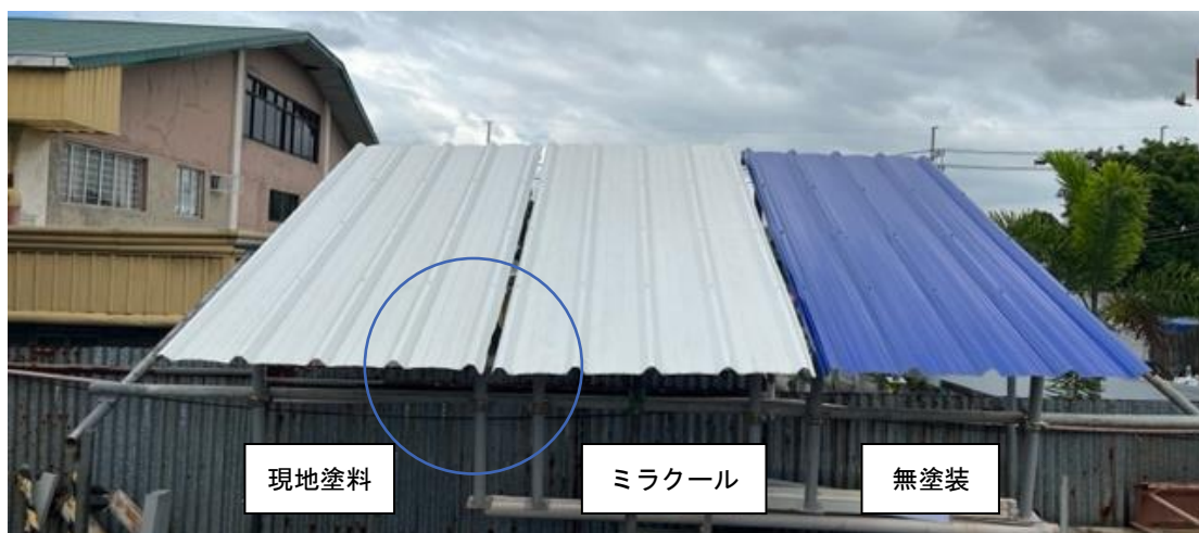
図 3 屋外での曝露試験状況（全体概観）
