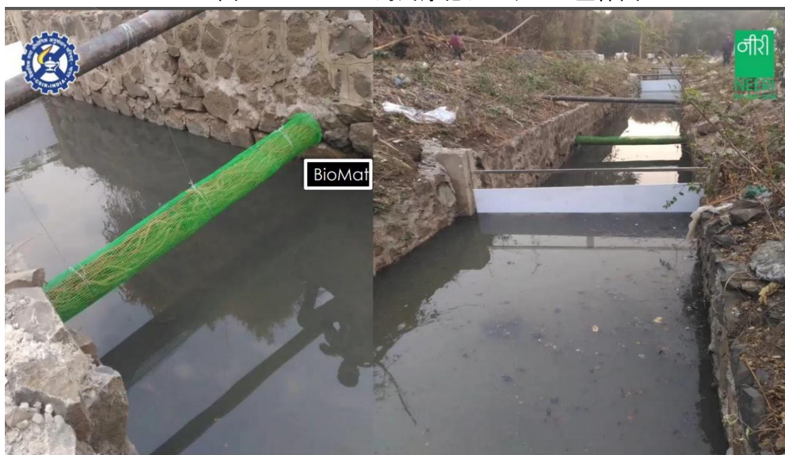
図2 NEERIの河川浄化システムに用いられる微生物担体
