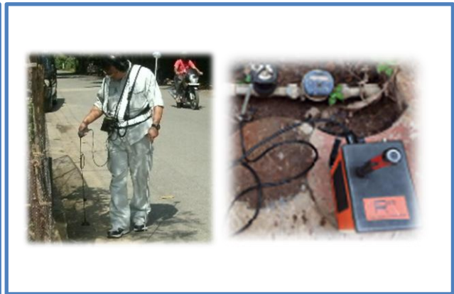
漏水検知技術の組合せによる 効率的な漏水箇所の特定
