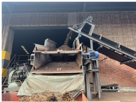
バイオマス燃料として出荷前の PKS の異物除去工程
