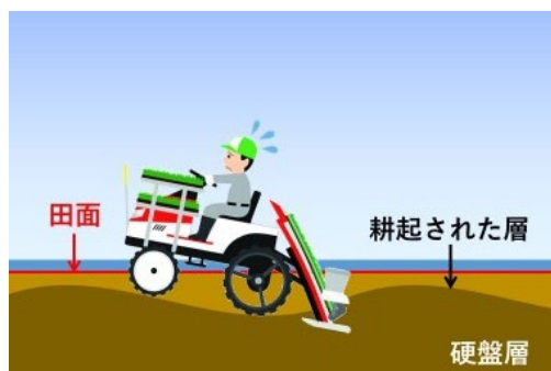
田面は均平だが 硬盤層が十分に形成されていない状態
