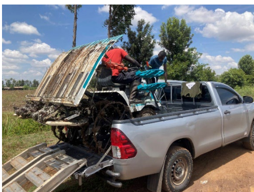
ピックアップトラックでの 4 条植え乗用田植え機の運搬
