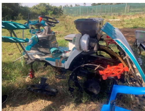
泥濘から引き上げる際に 前輪の車軸が折れた田植え機
