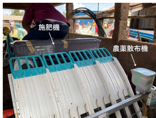
施肥機と農薬散布機を装着した田植え機
