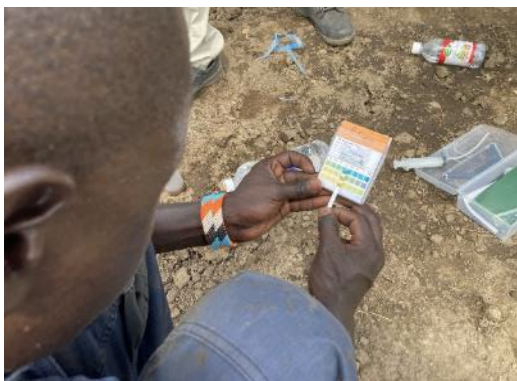
試験紙による培土の pH 測定
