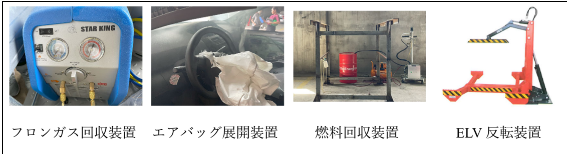
図 9 本実証期間に導入した主要な ELV 適正解体装置
