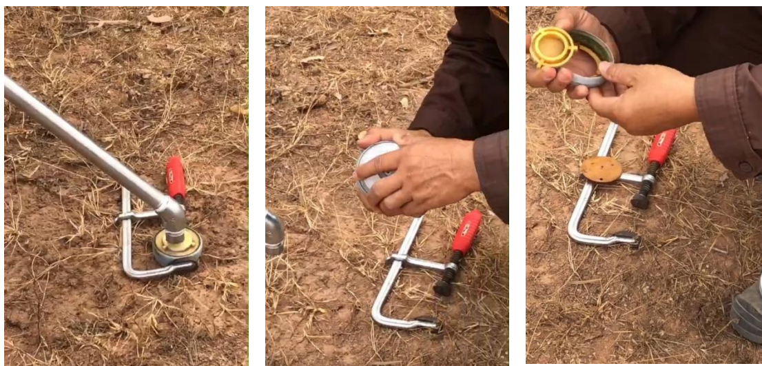
写真 15 16 17 爆薬を除去した地雷による起爆動作試験
