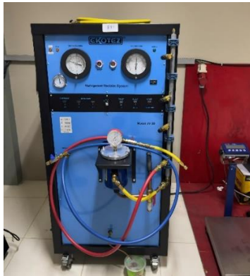
BBPVP Bekasi に導入された簡易再生機 (Ekotez 社製)
