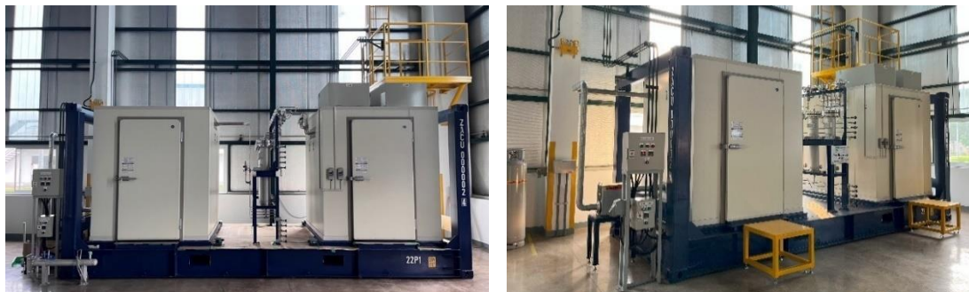
(2024 年 1 月に西ジャワ州 IIGI 工場内に導入した当社製フロンガス再生機)
