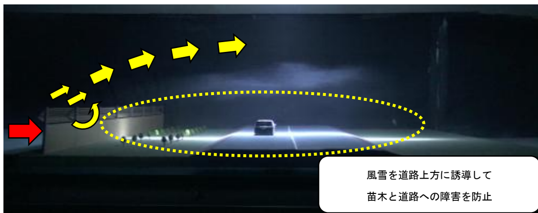
図 8）風洞実験検証 防雪柵配置（結果：視程障害緩和効果○、減風効果○）
