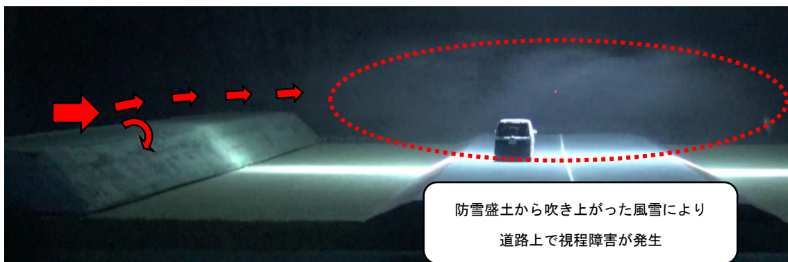
図 9）風洞実験検証 モ国現状（結果：視程障害緩和効果×、減風効果△）
