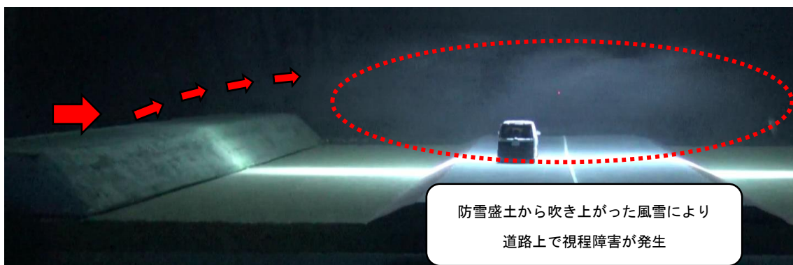
図 6）風洞実験による検証（結果：視程障害緩和効果×、減風効果△）
