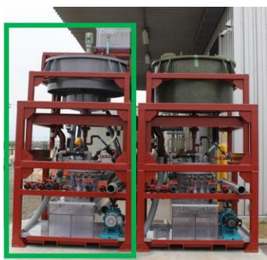
従来のリサイクル手法（破碎処理）では Pd、Ta 等のレアメタルを十分に再資源化できず、貴重な資源が路盤材などに流れていた。弊社製品は、基板から電子部品を丁寧に剥離処理し、それぞれの特性に合わせて選別処理を行うことで、レアメタルの高効率回収が可能となった。結果、資源回収効率が向上するだけでなく、Pd 等が有価物として新たに販売できるようになるため、従来手法と比較して経済価値を 20%UP させることができるようになった。更に塩化鉄等の湿式工程を組み合わせると、IC（集積回路）等から金回収が可能。途上国等投資体力の少ない国において、比較的小さな投資額で高品位の金濃縮まで一貫処理が可能となる。図 4-1 に Astec-system の特徴および分離回収について他社技術との比較を示す。
