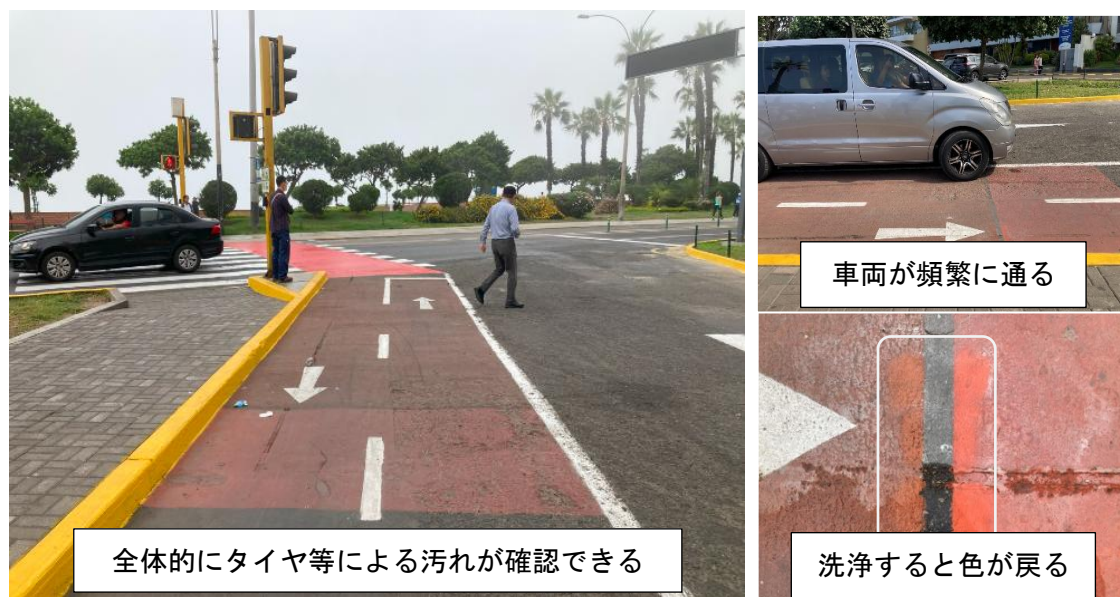
図 6 約 3 か月経過時。横断歩道上の鮮やかな赤色塗装は、試験施工から 2 か月後に同区が既存塗料を塗装した箇所である
