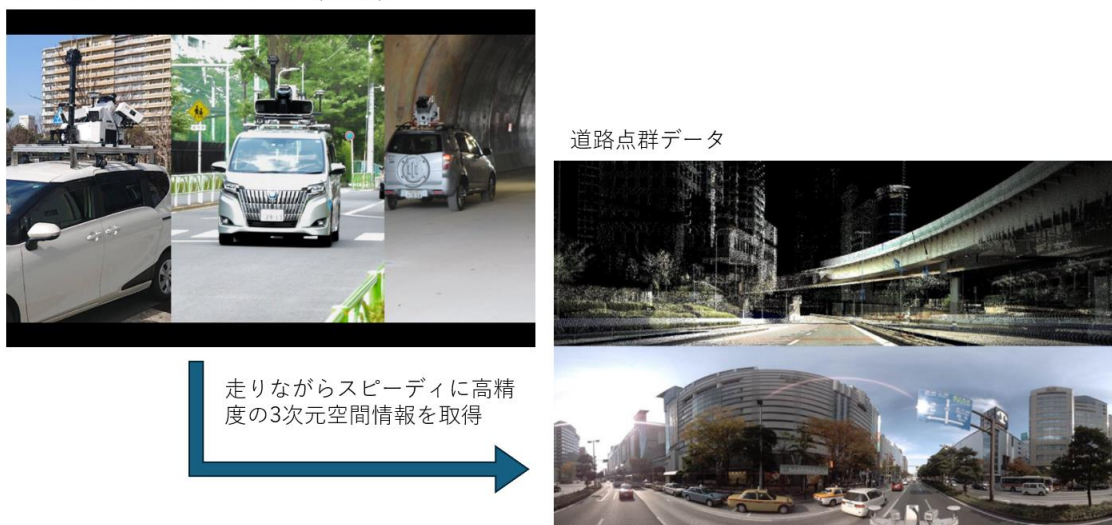
図 22 MMS により取得される道路点群データ
