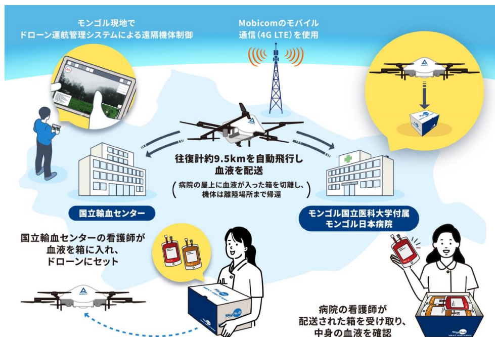
図 2 ドローン配送実証実験の流れと運航体制（ニーズ確認調査より）
