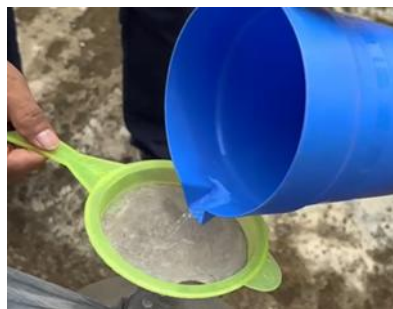
図 4.2.9 雨水のろ過の様子（網）
