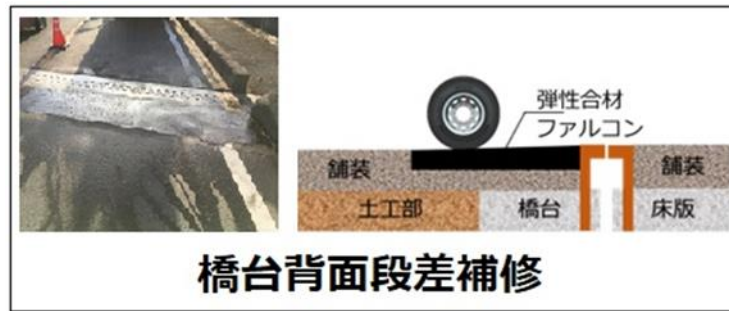
図 16 橋台背面段差補修イメージ
