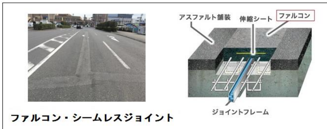
図 12 ファルコンシームレスジョイントの適用事例（左）と SJ 工法の構造（右）
