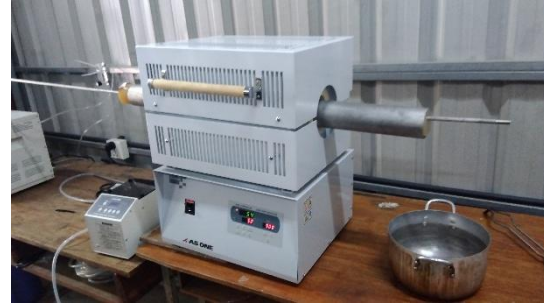
第3回現地調査：活性炭実証試験に利用した電気 環状炉 (2024年9月11日)
