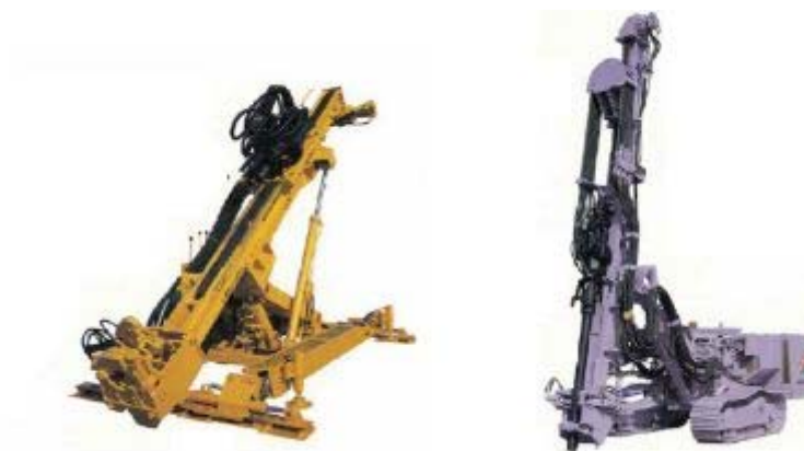
図 2-21：ロータリーパーカッション(RPD)式削孔機の例 (右：クローラー(自走)タイプ、左：スキッドタイプ，出展：三菱削孔機カタログ)
