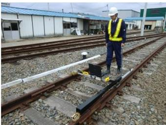
←レール上で検測作業中のメモレール
