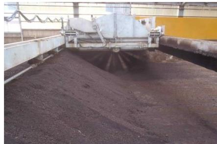
提案製品である「岡田式発酵攪拌装置」を活用しての、生ごみを原料とした堆肥化製造の様様
