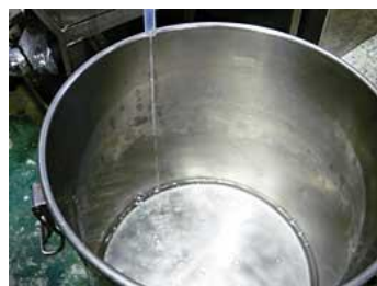
蒸留装置でリサイクルした溶剤
