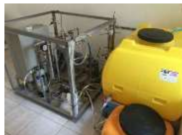
現地の水を飲料化する浄水機
