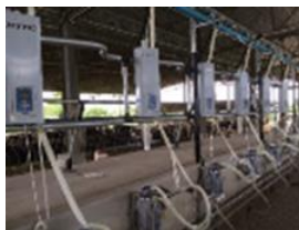
スーパーラインミルクカー (自動洗浄機能付搾乳システム)
