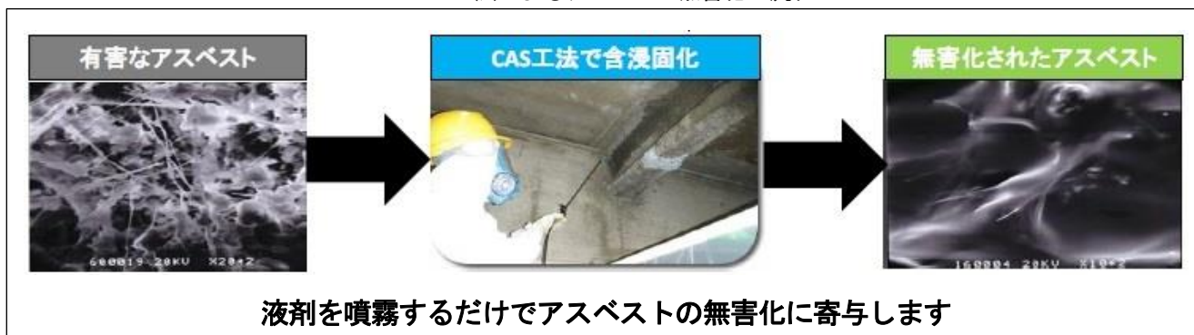
CAS工法によるアスベスト無害化の流れ
