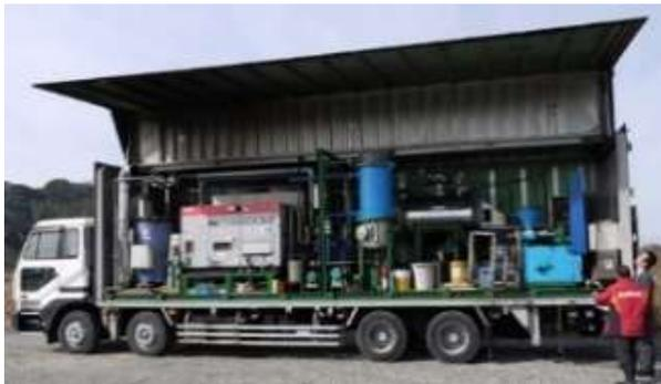
油温減圧式乾燥機を搭載したトラック
